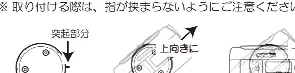
8.ブラケットは、固定ベルトのネジを緩めると、自由に動かすことができます。撮影する方向、角度を決定しましたらネジを締めて固定して下さい。(図6)(図7)
